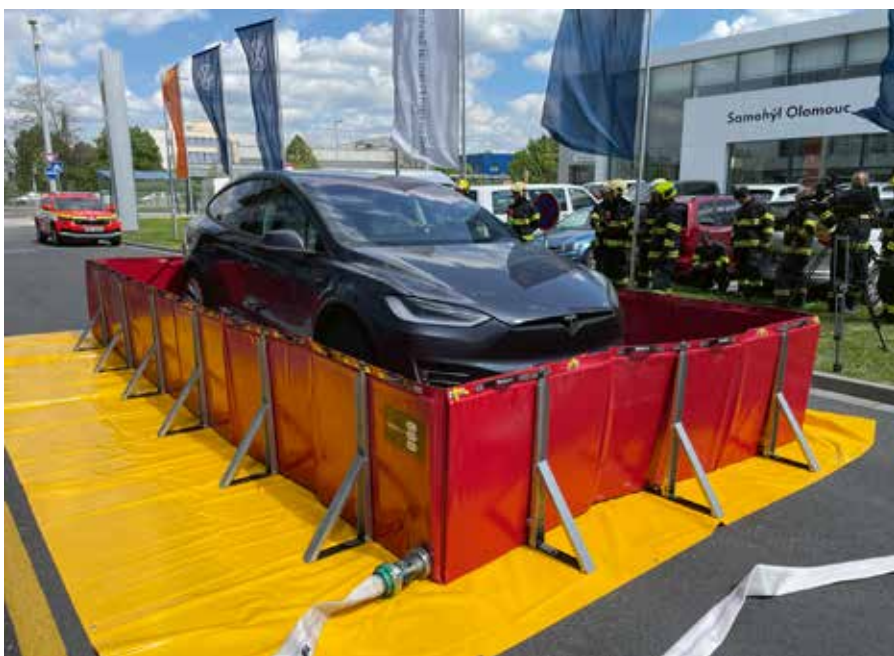
Skládací kontejner pro karanténní uskladnění poškozených elektromobilů
