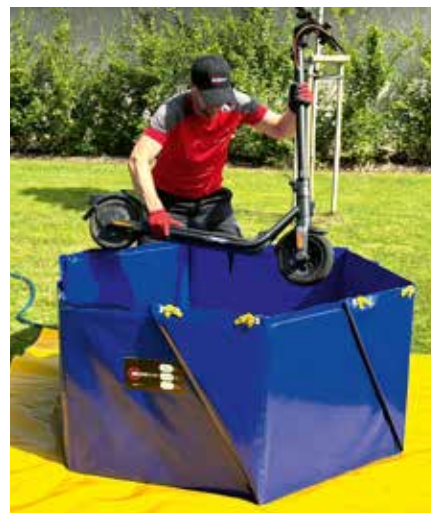
Samonosná skládací nádrž použitá pro hašení poškozené elektrokoloběžky
