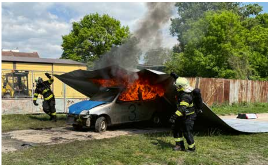
Hasící deka účinně eliminuje požár a toxické výpary z hořícího zařízení
